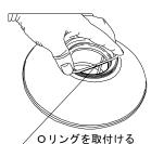
・ パーツc)を逆さまにして本商品付属の220φセート、の下側から入れ、Oリングを取り付けます。・・・図d)
